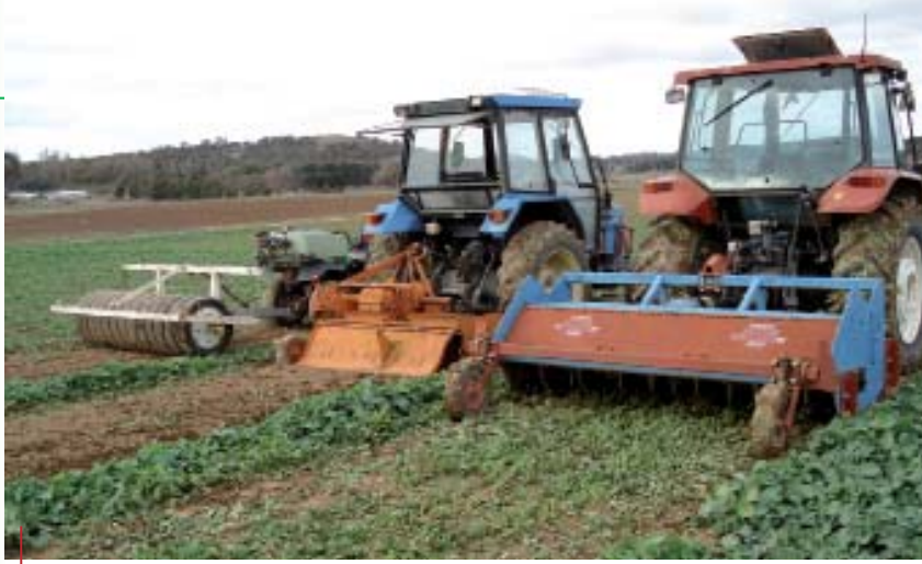
Die drei Stufen der Einarbeitung: Schlegeln, Fräsen, Walzen
